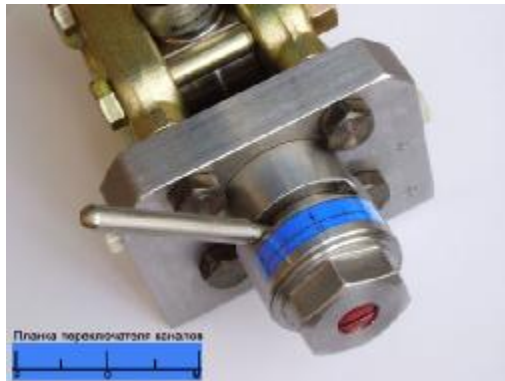
Положение переключателя каналов ББК-5 в режиме «Работа»
