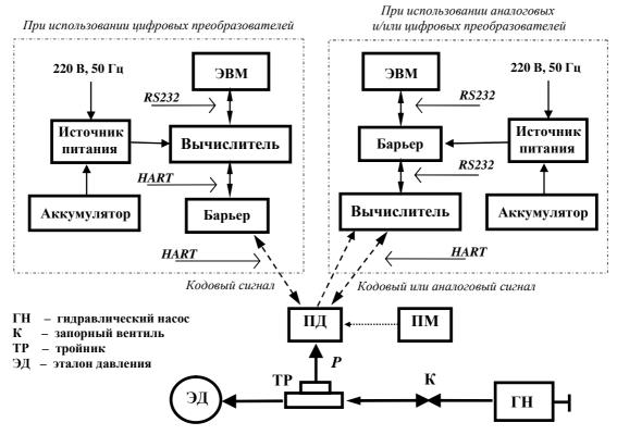
а) для Комплекса, использующего комплект измерительных преобразователей (модификация  $\Phi$ ЛОУТЭК-ТМ-Х-1) или преобразователь  $\Pi$ М (модификация  $\Phi$ ЛОУТЭК-ТМ-Х-2)
