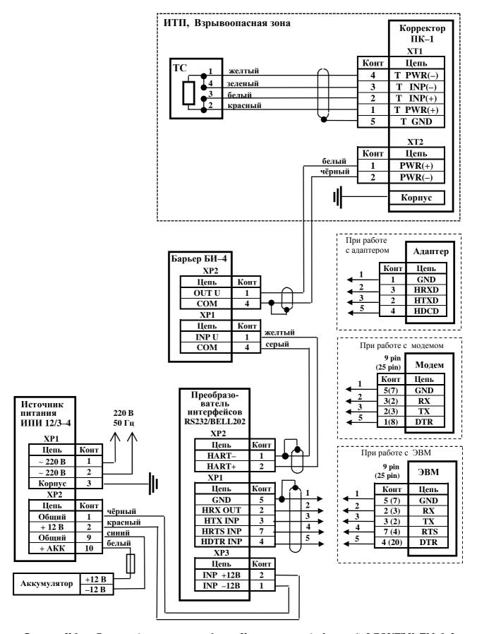
Рисунок К.1 – Схема подключения приборов Комплексов модификаций ФЛОУТЭК-ТМ-1-3 и ФЛОУТЭК-ТМ-2-3 (миникомплекс) при обслуживании одного трубопровода
