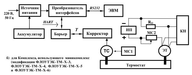
Рисунок 3.10 – Схема для проверки выполнения Комплексами измерений температуры
