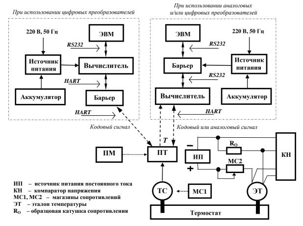
а) для Комплекса, использующего комплект измерительных преобразователей (модификация ФЛОУТЭК-ТМ-X-1) или преобразователь IIM (модификация ФЛОУТЭК-ТМ-X-2)
