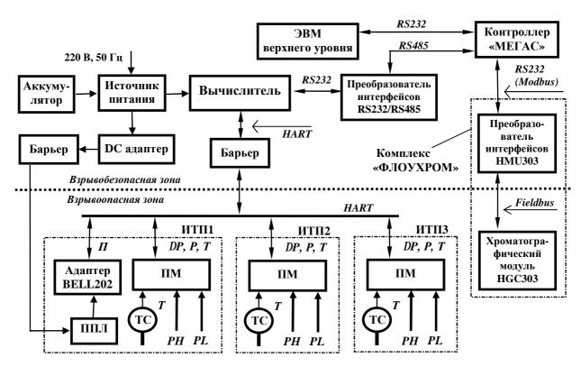
Рисунок 1.10 — Структурная схема Комплекса модификаций ФЛОУТЭК-ТМ-1-2 и ФЛОУТЭК-ТМ-2-2 при обслуживании трех трубопроводов и при работе с хроматографом
