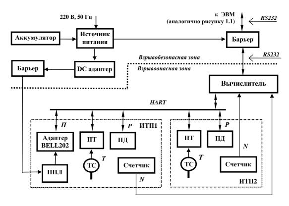
Рисунок 1.9 — Структурная схема Комплекса модификации ФЛОУТЭК-ТМ-3-1 при обслуживании двух трубопроводов и использовании счетчиков с импульсным выходным сигналом
