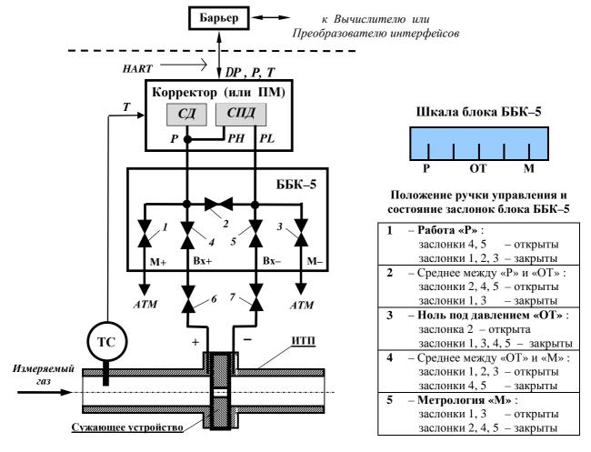
а) схема подключения с помощью блока ББК-5
