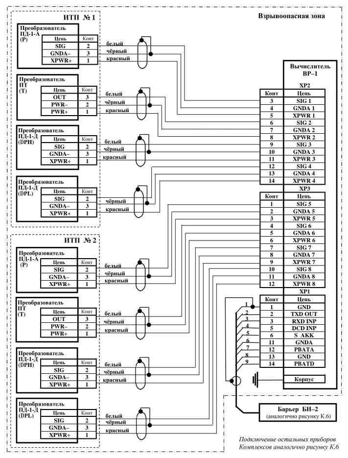
Рисунок К.9 — Схема подключения измерительных преобразователей с аналоговыми выходными сигналами к вычислителю Комплексов модификаций ФЛОУТЭК-ТМ-1-1 и ФЛОУТЭК-ТМ-2-1 при обслуживании двух трубопроводов
