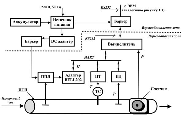
а) Комплекс модификации ФЛОУТЭК-ТМ-3-1 при использовании счетчика с импульсным выходным сигналом
