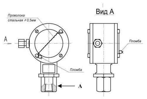
Рисунок Л.3 – Схема размещения пломб на преобразователе модификаций ПД-1-A и ПД-1-И
