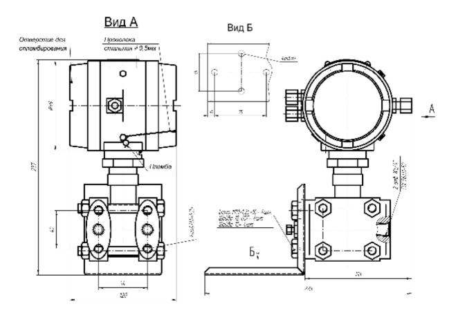
Рисунок Л.5 – Габаритные размеры преобразователя модификации ПД–1–Д в сборке с кронштейном крепления и местом пломбирования.
