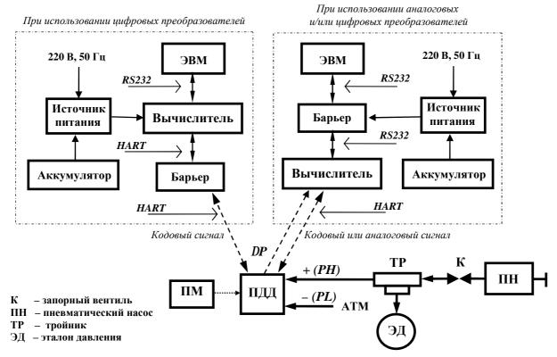
а) для Комплекса, использующего комплект измерительных преобразователей (модификации ФЛОУТЭК-ТМ-X-1 и ФЛОУТЭК-ТМ-X-4) или преобразователь IIM (модификация "ФЛОУТЭК-ТМ-X-2")
