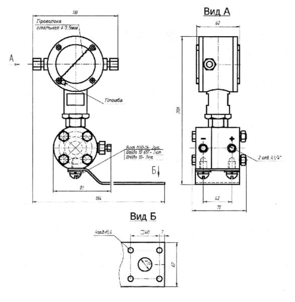
Рисунок Л.4 – Схема размещения пломб на преобразователе модификаций ПД-1-Д
