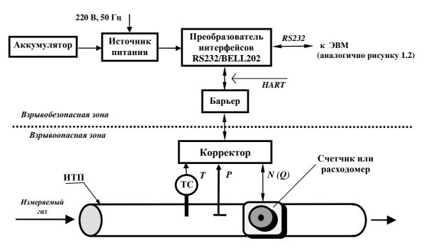
Рисунок 1.4 — Структурная схема Комплексов модификаций ФЛОУТЭК-ТМ-3-4 и ФЛОУТЭК-ТМ-4-4 при обслуживании одного трубопровода
