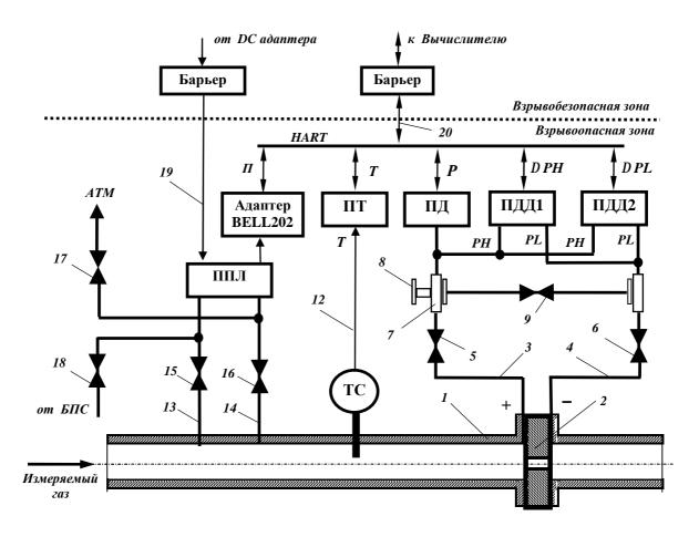
Рисунок 3.2 — Схема подключения измерительного преобразователя плотности и измерительных преобразователей Комплексов модификаций ФЛОУТЭК-ТМ-1-1 и ФЛОУТЭК-ТМ-2-1 к трубопроводу (на открытом воздухе) с помощью трехвентильного блока
