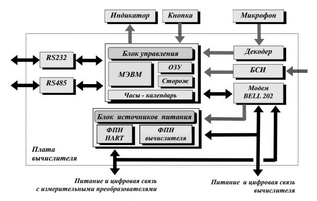
Рисунок 2.2 – Структурная схема вычислителя ВР
