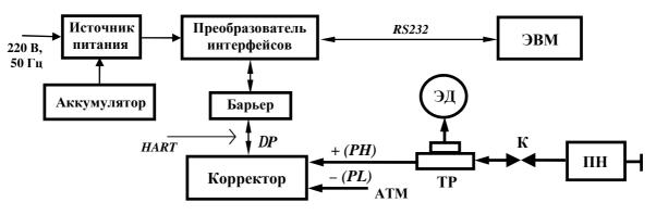
б) для Комплекса, использующего миникомплекс (модификации ФЛОУТЭК-ТМ-Х-3 и ФЛОУТЭК-ТМ-Х-5)
