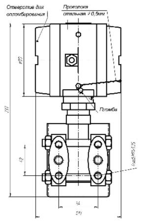
Рисунок Л.1 – Схема размещения пломбы на многопараметрическом преобразователе – вычислителе ПМ-3H
