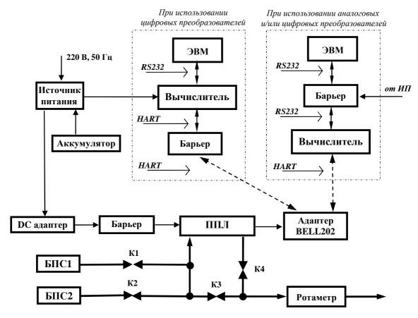
БПС1, БПС2 – баллоны с поверочной смесью, оснащенные редуктором K1-K4 – запорные вентили
