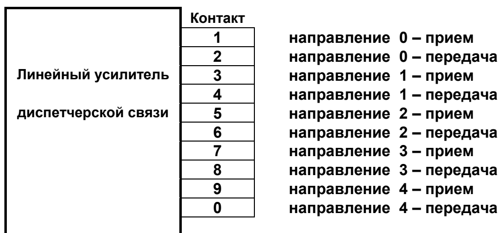
Рис. 4.1. Подключение линий связи к плинту LSA-Plus
