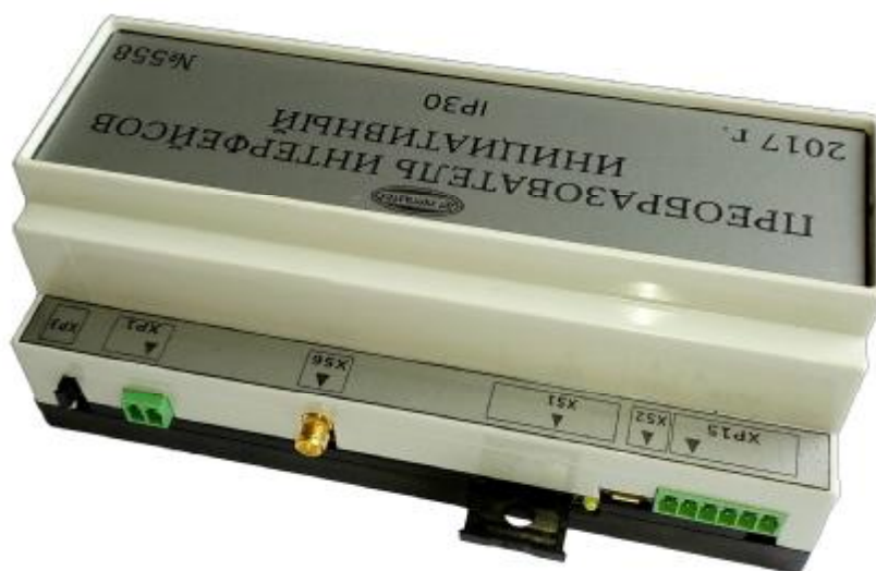
Рис. 3б - Вид перетворювача інтерфейсів ініціативного-ТМ з боку підключення живлення (XP1), антени (XS6) та з'ємної SIM-карти
