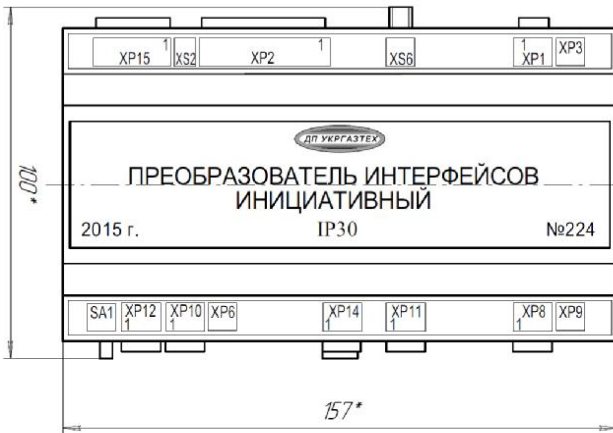
Рис. 2 - Внешний вид и наименование используемых разъемов преобразователя интерфейсов инициативного
