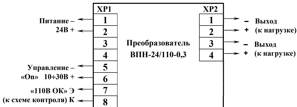
Рисунок 3.1. Внешние подключения преобразователя.
