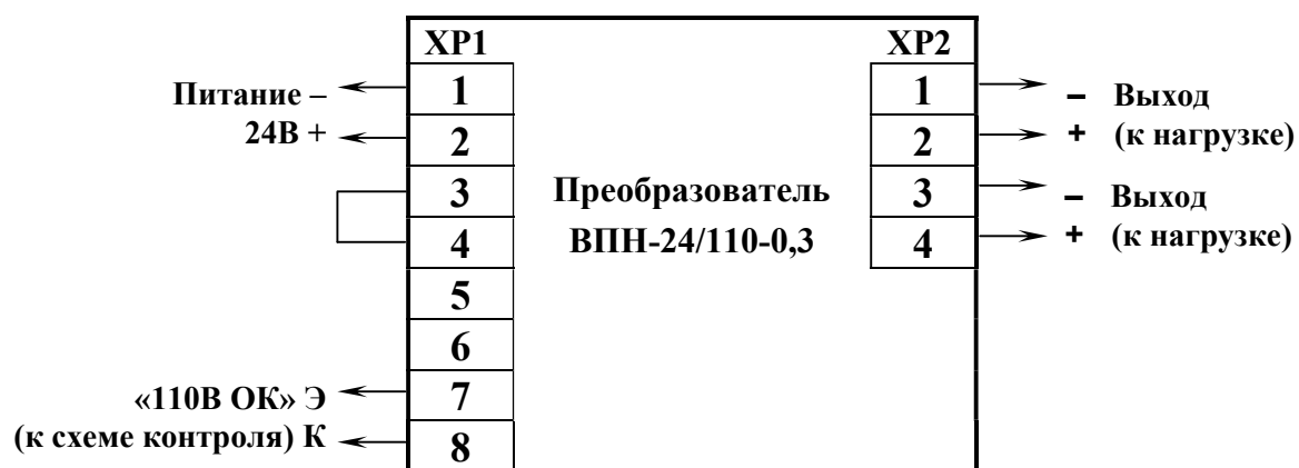
Рисунок 3.3. Внешние подключения преобразователя без использования сигнала управления.
