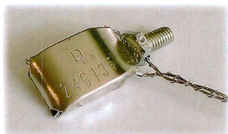
Рисунок 5. — Загальний вигляд пломб, що застосовуються виробником перетворювачів
