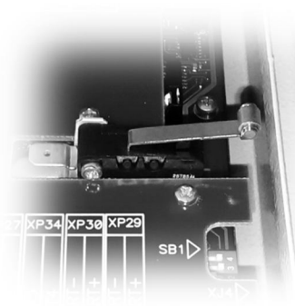
Рисунок 3. Схема пломбування обчислювачів модифікації «ВР-2»
